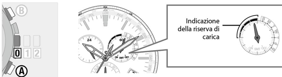
Premere il pulsante A per ripristinare l'indicazione normale. L'indicazione normale torna ad essere visualizzata automaticamente dopo 10 secondi, senza la necessità di premere alcun pulsante.
