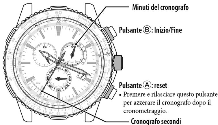
Dopo 60 minuti di funzionamento continuo del cronografo, il cronografo si ferma e si azzerà automaticamente.
