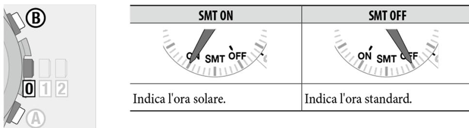
Premere il pulsante B per ripristinare l'indicazione normale. L'indicazione normale torna ad essere visualizzata automaticamente dopo 10 secondi, senza la necessità di premere alcun pulsante.
