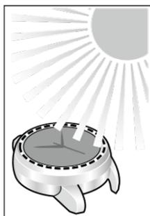
L'orologio ha una cella solare sotto il quadrante e conserva la potenza generata dalla cella nella cella ricaricabile incorporata. La cella viene ricaricata esponendo il quadrante alla luce, ad esempio la luce solare diretta o lampade fluorescenti.
