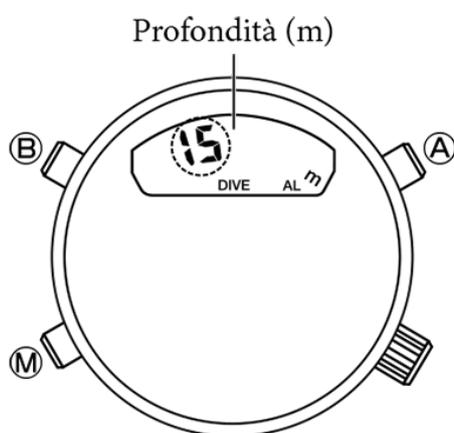
1. Premere il pulsante M per passare alla modalità allarme profondità. L'indicazione della profondità lampeggia.
