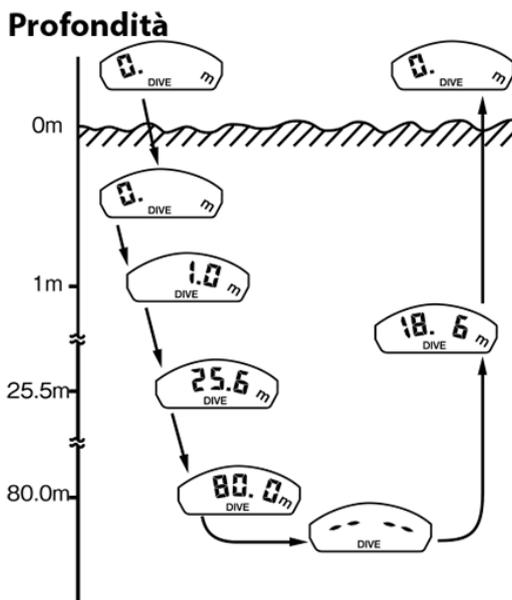
La prima misurazione della profondità dell'acqua viene effettuata e indicata a 1,0 metri; la misurazione viene effettuata e indicata ogni secondo.
