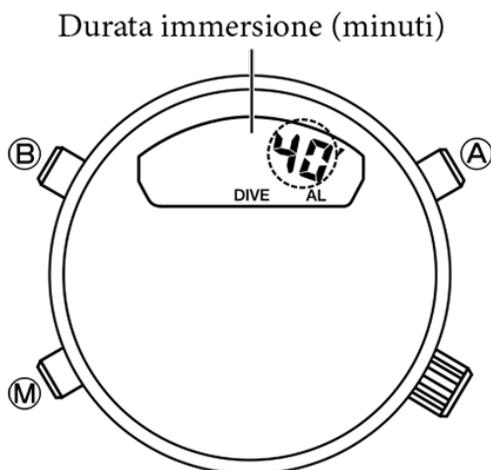
1. Premere il pulsante M per passare alla la modalità allarme durata immersione. L'indicazione della durata dell'immersione lampeggia.
