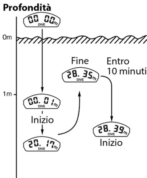
La misurazione della durata dell'immersione inizia automaticamente quando viene rilevata una profondità pari o superiore a 1,0 metro e si interrompe quando la profondità è inferiore a 1,0 metro. Se tuttavia la profondità torna uguale o superiore a 1,0 metro entro 10 minuti, l'orologio continua a indicare la misurazione della durata dell'immersione dal punto in cui si era interrotta.
