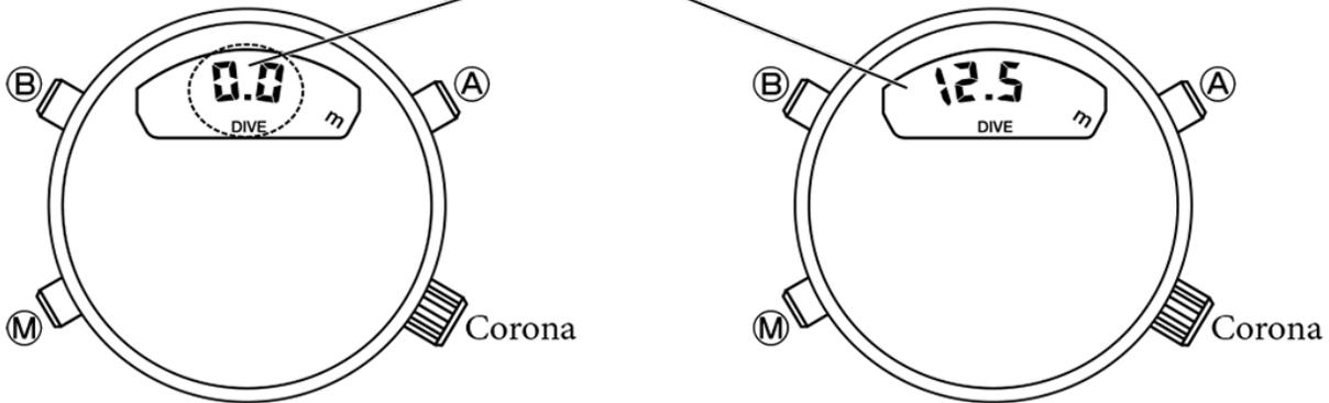
□ Se si preme il pulsante A durante l'immersione, la durata dell'immersione viene indicata per 2-3 secondi. Se si preme di nuovo il pulsante A mentre viene visualizzata la durata di un'immersione, la profondità massima viene visualizzata per 2-3 secondi.
